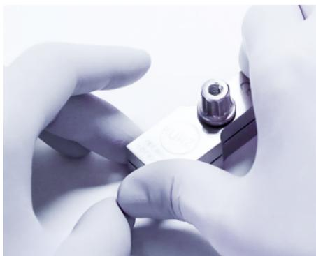
4. 旋转切割块顶部直至与底部完全贴合。拧紧螺母以固定切割模块于该位置并
