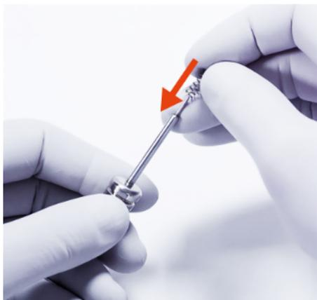
1. 选取带圆形端的打孔部件（部件 1）。将弹簧套入轴杆。
