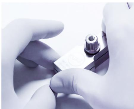
2. 旋转切割块顶部直至与底部完全贴合。拧紧螺母以固定切割模块于该位置。注意：拧紧螺母至切割块两部分与软骨稳固贴合，但确保软骨不被压损。
