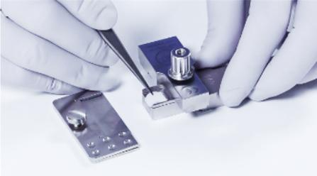
4. 取下刀片。厚度明确的软骨移植物留存于切割块底部。用镊子取出该软骨移植物。
