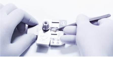
2. 放下切割块，旋松螺母并将顶部旋转 90 度。
