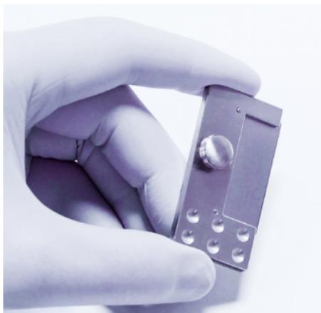
4. 将无定位针的刀片支架部件（部件 2）精准扣合到部件 1 及刀片上。
