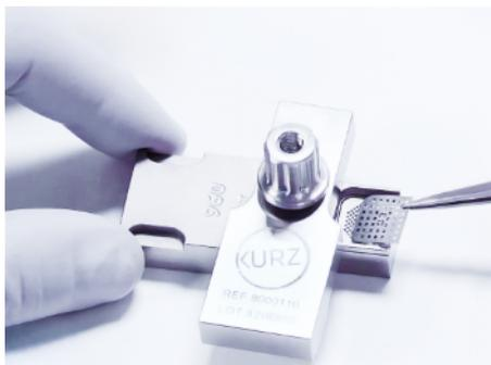
2. 将 1 毫米的定距板放入切割块底部的凹槽中。
