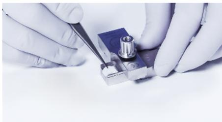
5. 放下切割块，旋松螺母并将顶部旋转 90 度。
